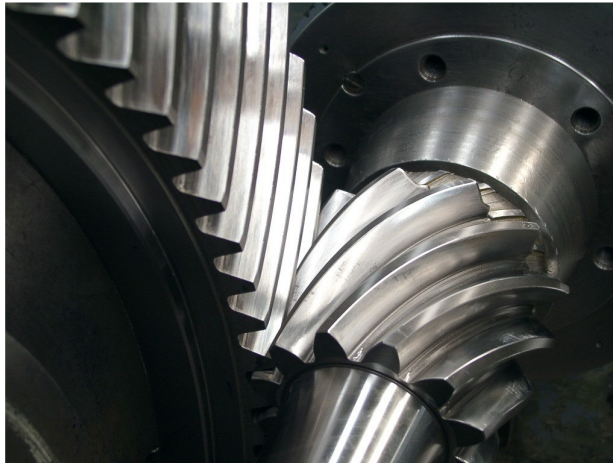
Figura N°1 - Accoppiamento di due ingranaggi cilindrici elicoidali.
